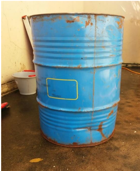
FIGURA 2 – Tambor de latão com 200 litros utilizado como reservatório
